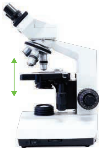
Afb. 8 Een microscoop waarbij de tafel omhoog en omlaag kan.
